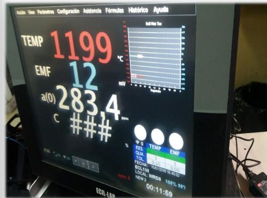
Equipo que permite el **control operacional** en los procesos de fundición, registrando datos de T° y O2 en Hornos.
